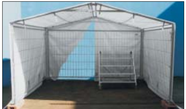
6. Ein fertig erstelltes Bauzaunzelt, die Giebelplane ist teilbar
